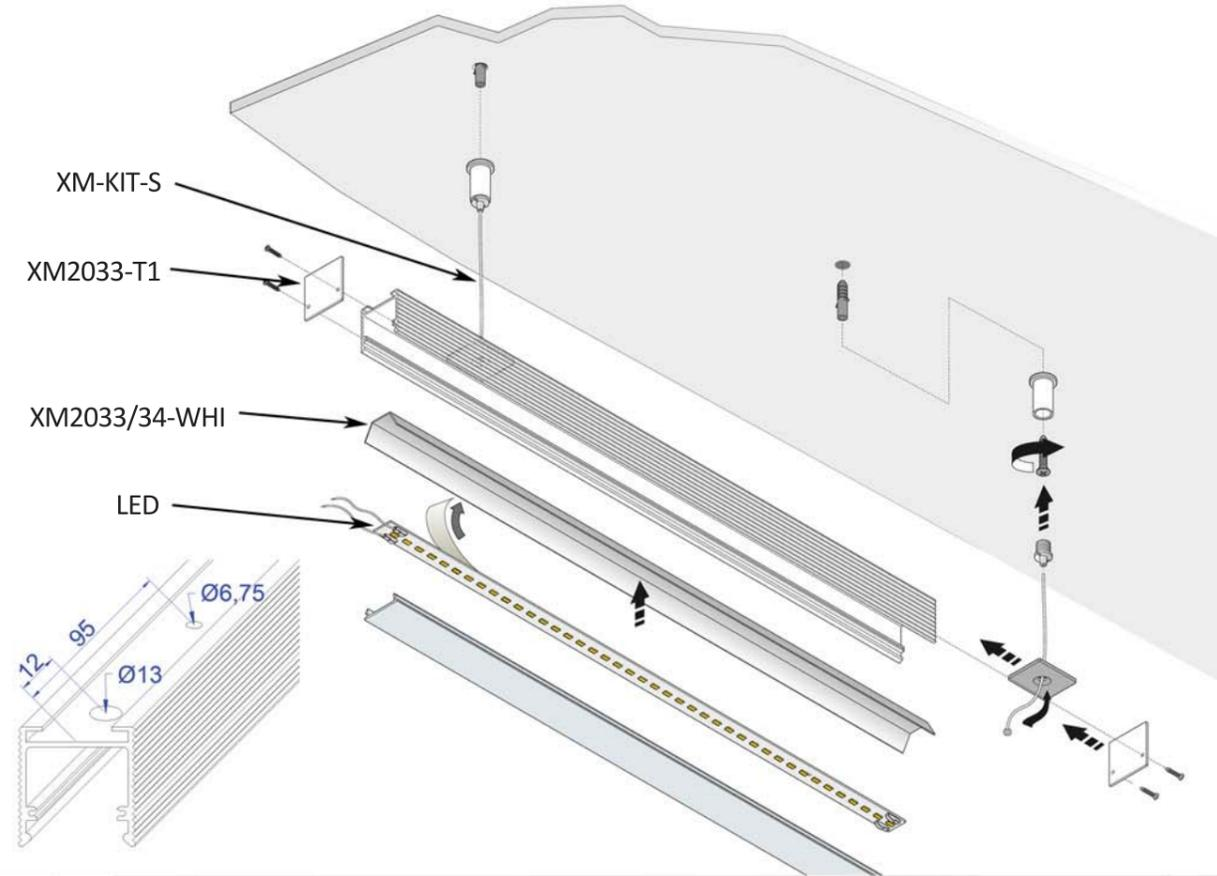
INSTALLAZIONE A SOFFITTO/PARETE CEILING/WALL INSTALLATION DECKEN/WAND INSTALLATION INSTALLATION AU PLAFOND/MUR
